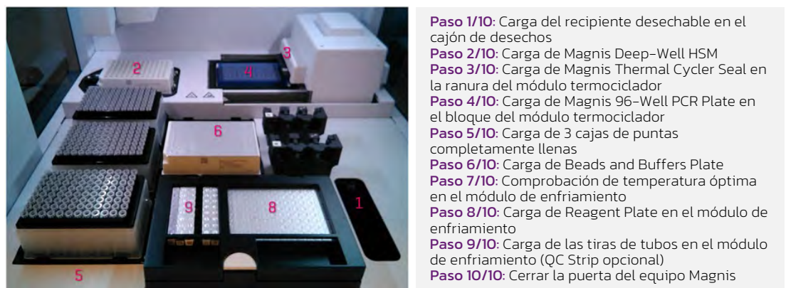
Figura 5. Unidad del instrumento Magnis NGS Prep cargada para el ensayo y guía rápida de carga
