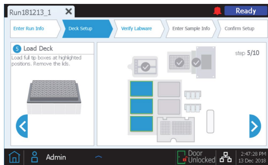
Figura 10. Paso 5 de 10 de la pantalla Deck Setup del equipo Magnis NGS Prep
