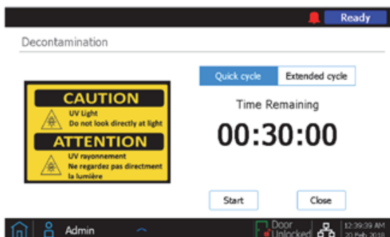
Figura 2. Pantalla Decontamination del sistema Magnis NGS Prep
