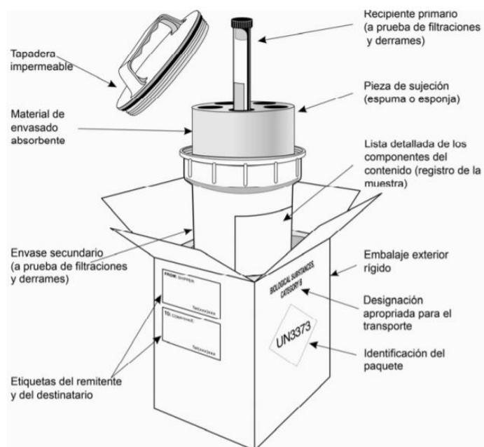
Fig. 3: Ejemplo de sistema de embalaje/ensado triple para el embalaje y etiquetado de sustancias potencialmente infecciosas.
